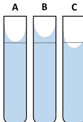
Figura 4.4. Meniscos. **A**, aforo correcto. **B** y **C**, aforo incorrecto.
